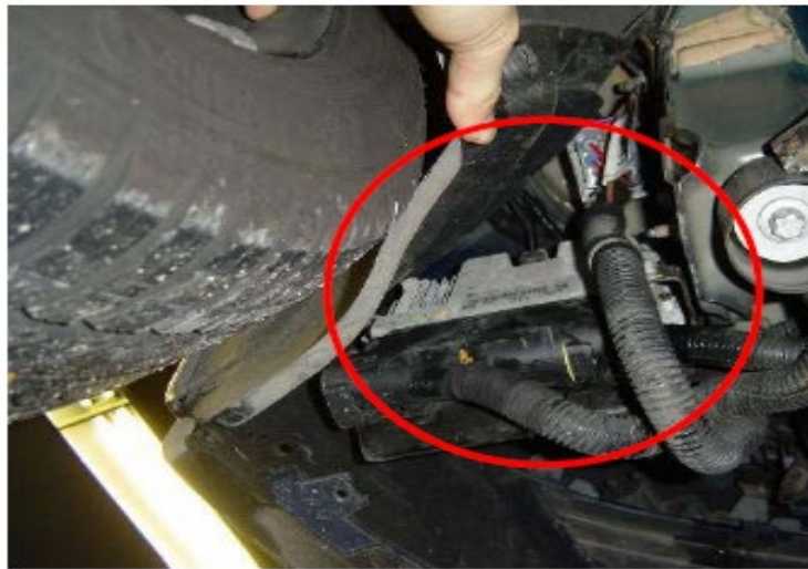
Abbildung 7: kritischer Einbauort bezüglich Korrosion und Wasserlast
